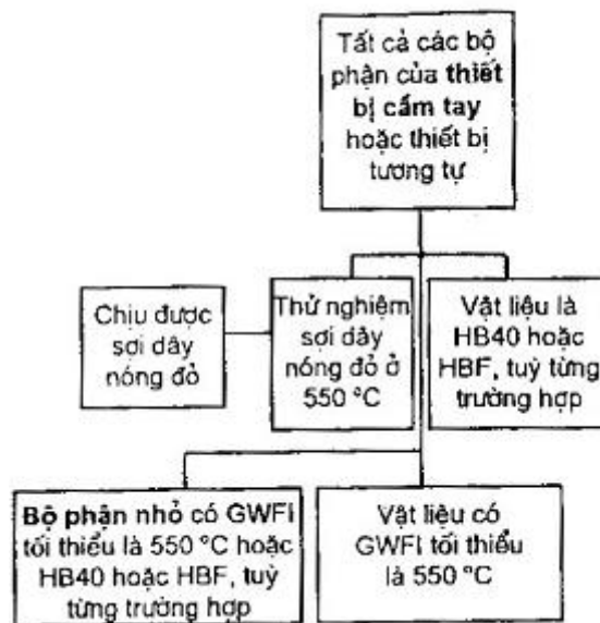
Hình O.2 - Lựa chọn và trình tự thử nghiệm khả năng chịu cháy trong thiết bị cầm tay
